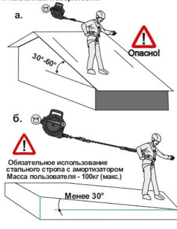
Рис. 9. Использование на горизонтальных и наклонных поверхностях
