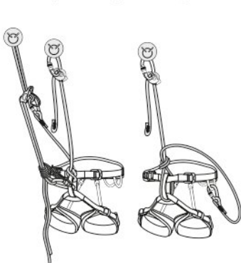
Рис. 8. Применение усов самостраховки
