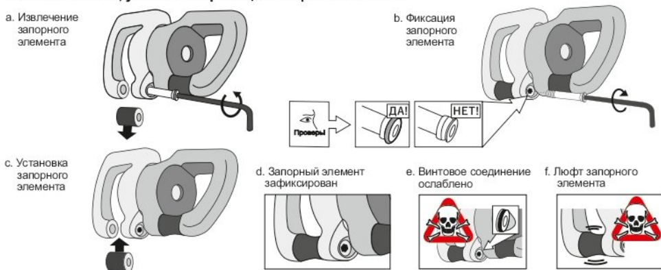
Рис. 4. Извлечение, установка и фиксация запорного элемента
