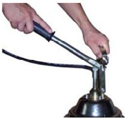
3. Откройте шаровой клапан смазочного пистолета (горизонтально) для подачи смазки.
