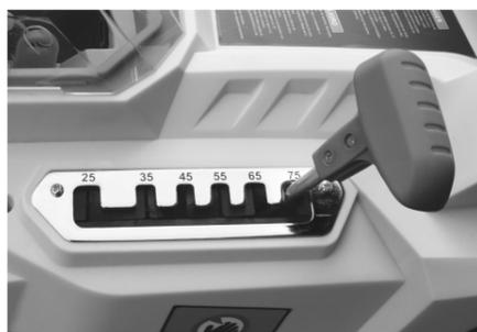
Устройство имеет 6 положений регулировки высоты среза:
