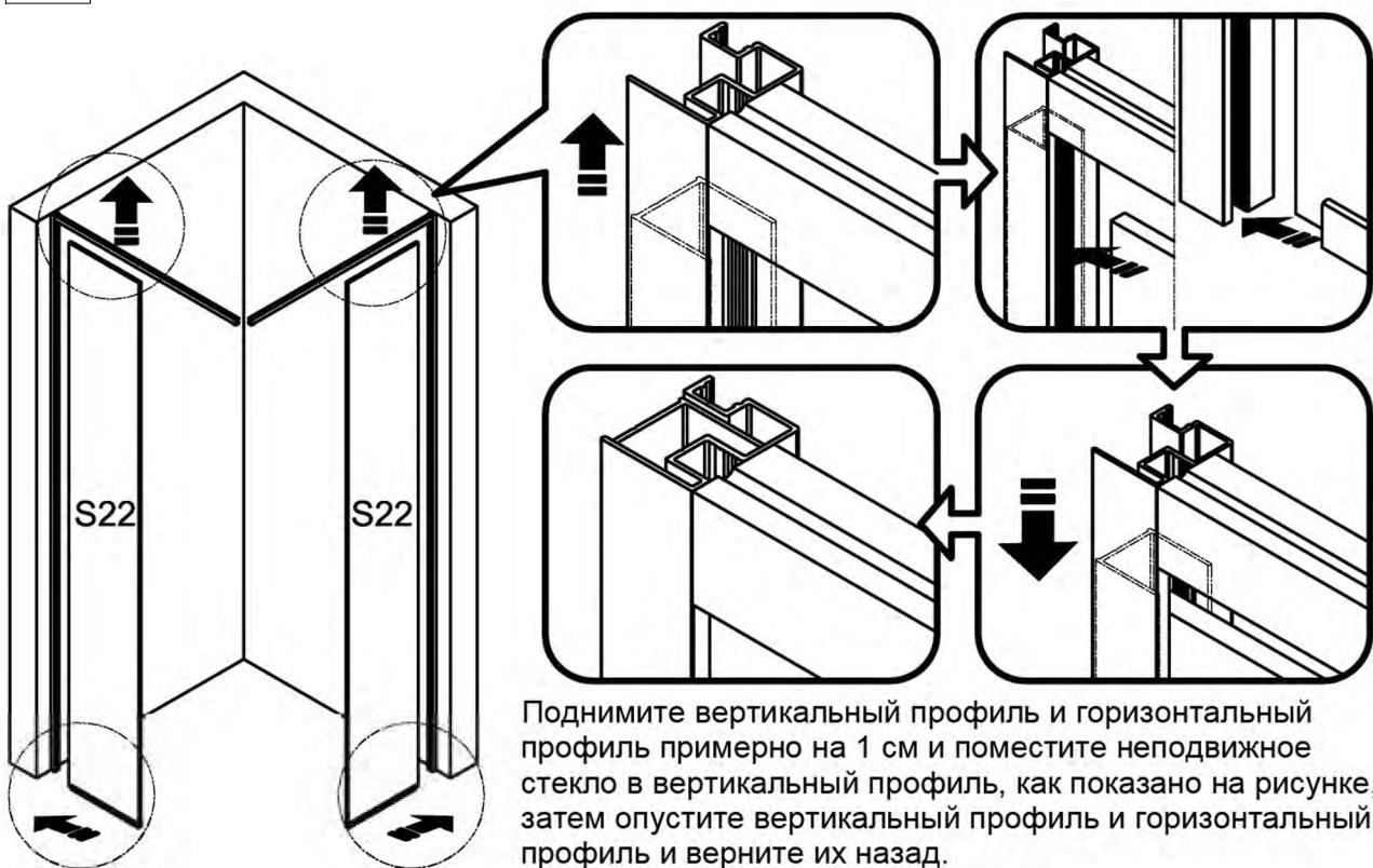
Поднимите вертикальный профиль и горизонтальный профиль примерно на 1 см и поместите неподвижное стекло в вертикальный профиль, как показано на рисунке, затем опустите вертикальный профиль и горизонтальный профиль и верните их назад.
