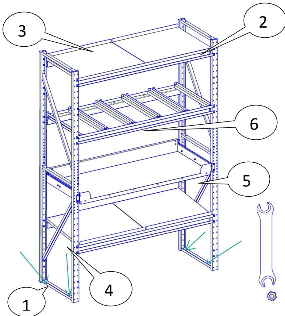
**Внимание!** Сборку производить снизу-вверх. Полки требуют диагонального ввода. Раму анкерить к полу на последнем этапе сборки.
