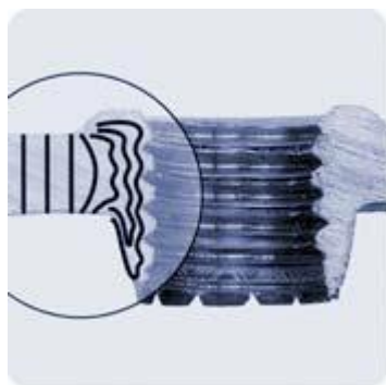
Рис. 19-2: Ориентация слоев металла в сформованной резьбе.
