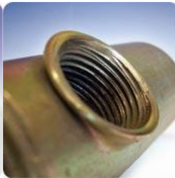
Рис. 5-2. Формовка отверстий трением в круглой трубе
