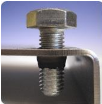
Рис. 5-1. Формовка отверстия трением и последующая формовка резьбы в стальном листе
