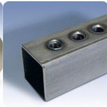
Рис. 5-3. Формовка отверстий трением в прямоугольной трубе
