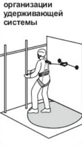
Рис. 12. Способ организации удерживающей системы
