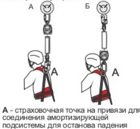
Рис. 5. Общие принципы использования карабинов
