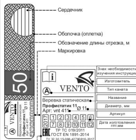
Рис. 1. Составные части и маркировка изделия
