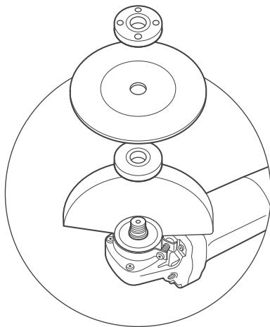
1. Наденьте внутренний фланец <sup>(7)</sup> на шпиндель. Обеспечьте совмещение шлицов фланца и шпинделя.
