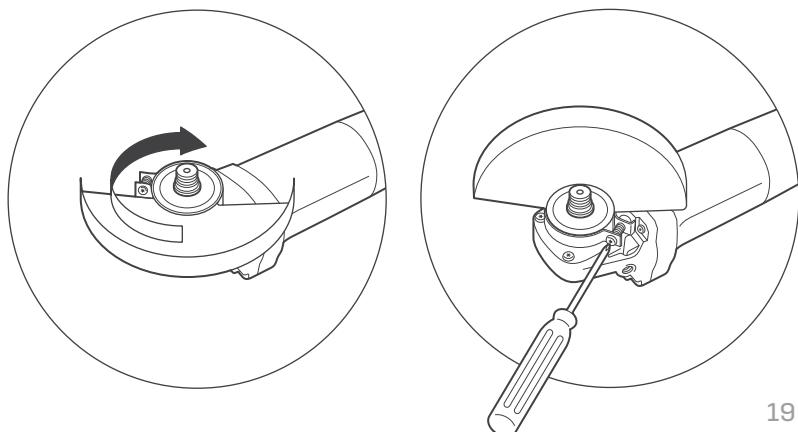
Установите защитный кожух так, чтобы исключить выброс искр в направлении оператора.
