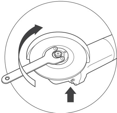
4. Нажмите кнопку стопора вала ①, слегка проверните приводной вал до фиксации. Затяните наружный фланец при помощи ключа для наружного фланца.
