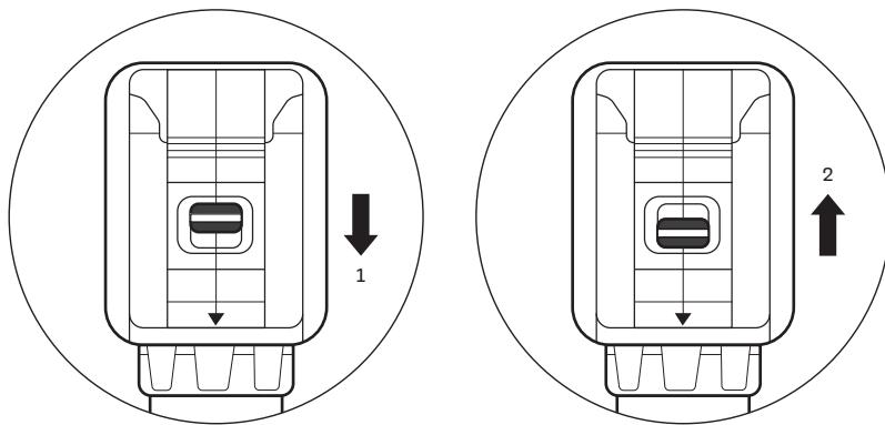
Механическая регулировка скоростного режима ④ позволяет настроить инструмент в соответствии с условиями работы. Вы можете установить низкий скоростной режим с высоким крутящим моментом для работ с крепежом или высокий скоростной режим — для выполнения сверлильных работ.
