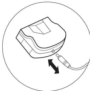
2. Вставьте штекер зарядного устройства в разъём аккумулятора/установите зарядный коннектор на батарею/установите аккумулятор на зарядное устройство (в зависимости от типа вашего зарядного устройства), зелёный индикатор погаснет, загорится красный — начнётся процесс зарядки батареи.
