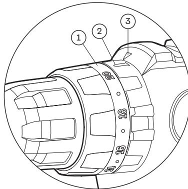
Дрели-шуруповёрты NBDI-12.2.20.A и NBDI-20.2.20.A способны работать в режиме сверления с ударом. Для включения режима сверления с ударом поверните кольцо ② так, чтобы положение
