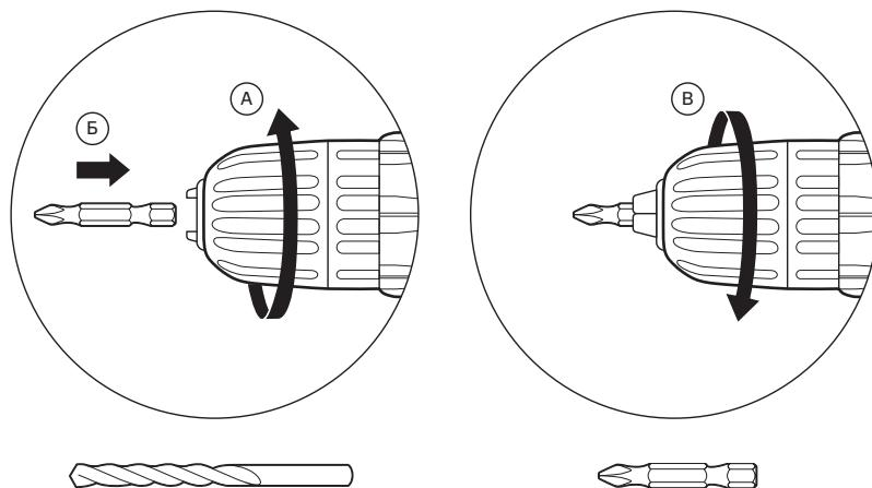
Инструмент оснащён быстрозажимным кулачковым патроном. Разведите кулачки патрона **(А)**, вставьте оснастку **(Б)**. Удерживая одной рукой малую муфту быстрозажимного патрона, другой рукой поверните большую муфту быстрозажимного патрона в обратном направлении **(В)** до надёжного закрепления оснастки.
