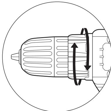
Чтобы установить крутящий момент, поверните и установите муфту регулировки крутящего момента ② в нужное положение. Значения крутящего момента обозначены цифрами на поворотном переключателе муфты. Совместите одну из цифр на муфте с указателем на внешнем корпусе инструмента.
