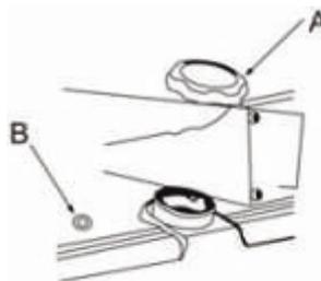
А. Крышка топливного бака
