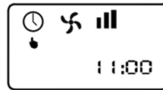
Рис. 5 Начальный интерфейс (функция синхронизации выключена)
