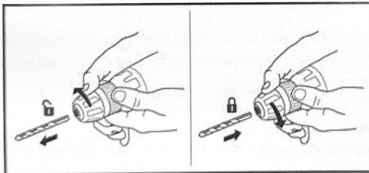
Все промышленные биты и сверла до диаметра 10мм могут зажиматься в сверлильный патрон. Сверлильный патрон дрели-шуруповерта правого и левого хода всегда фиксируется винтом с левосторонней резьбой. Перед заменой сверлильного патрона его можно открутить спереди через
