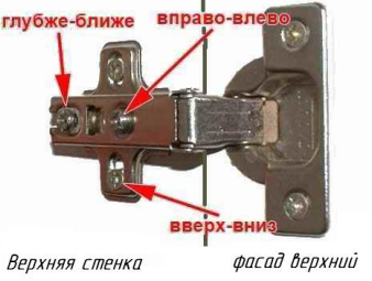
Рис.3 Установка вкладной петли
