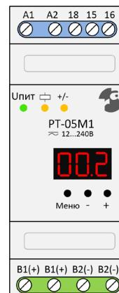
**ВНИМАНИЕ!** При контроле токов свыше 25А должны быть задействованы **ПАРЫ** клемм B1 и B2, т.е. подключение должно производиться к B1+B1 и B2+B2! В противном случае работоспособность реле **НЕ ГАРАНТИРУЕТСЯ!**
