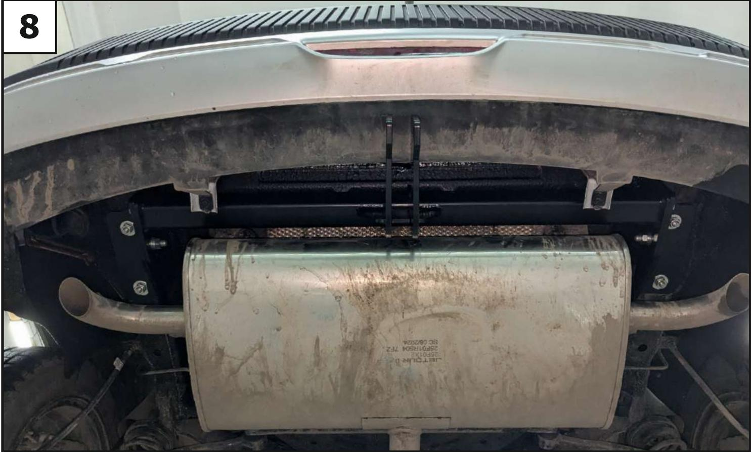
Отрегулировать положение ТСУ относительно центра автомобиля. Затянуть все резьбовые соединения: сначала балку с кронштейнами, затем кронштейны с лонжеронами автомобиля. Моменты затяжки: M10=47 Нм, M12=81 Нм. Установить глушитель на подвесы.
