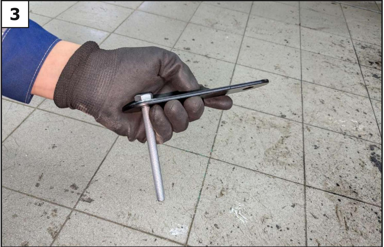
Со стороны багажного отделения в просверленные отверстия установить болты M10x110 (8) с помощью пластин (6) и шайб 10 увеличенных (14).
