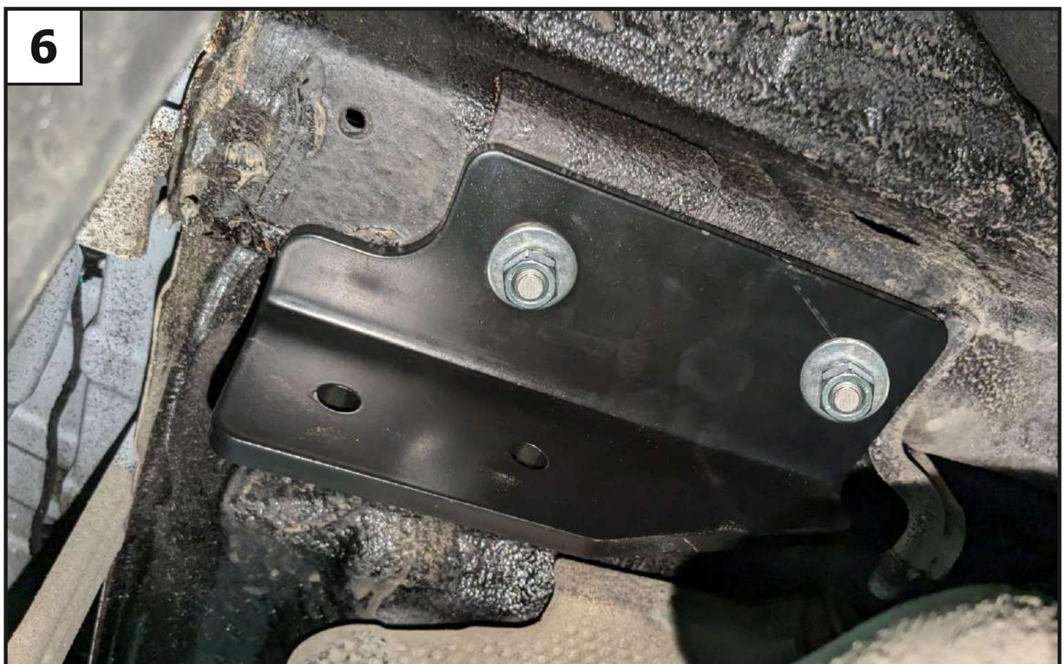
**Со стороны багажного отделения рассверлить полученные отверстия до диаметра 20 мм. Закрепить кронштейны (4 и 5) с помощью втулок (7), болтов M10x110 (8), шайб 10 пружинных (13), шайб 10 увеличенных (14) и гаек M10 (11).**
