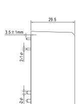
AC/L, AC/N P/N diameter:1  $\psi$  +V, -V P/N diameter:2  $\psi$
