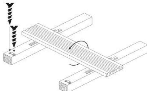
Перевернуть доску лицевой стороной вверх. Установить на лаги стартовые фиксаторы в соответствии с выступающими концами крепежей первой доски и закрепить с помощью двух саморезов.
