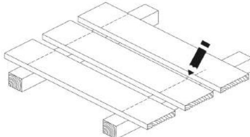
Произвести разметку на тыльной стороне доски в местах предполагаемого соединения доски с лагами (проводить поперечные линии на доске вдоль центра плоскости соприкосновения с лагами).
