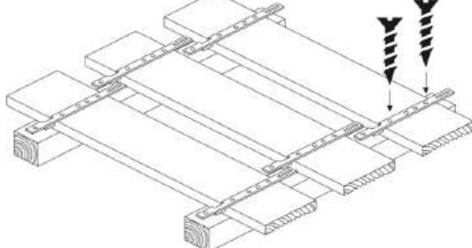
Разместить крепежи Змейка® на тыльной стороне доски в соответствии с разметкой (справа и слева от разметки на доске поочередно) и закрепить с помощью двух саморезов. Вынос «головы» крепежа за пределы доски определяется стопором (при наличии).
