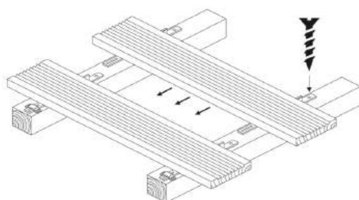
Завести крепежи Змейка® следующей доски под предыдущую до стопора или до получения необходимого зазора (при отсутствии стопора) и закрепить на лаге с помощью самореза.
