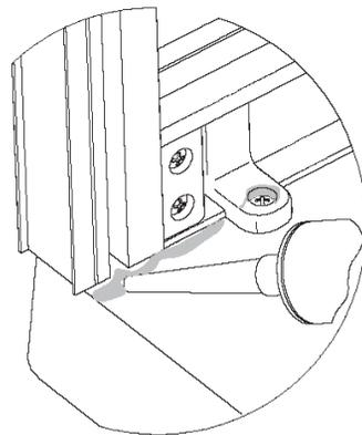
Крепление к стене в комплектации "без задних стенок"
