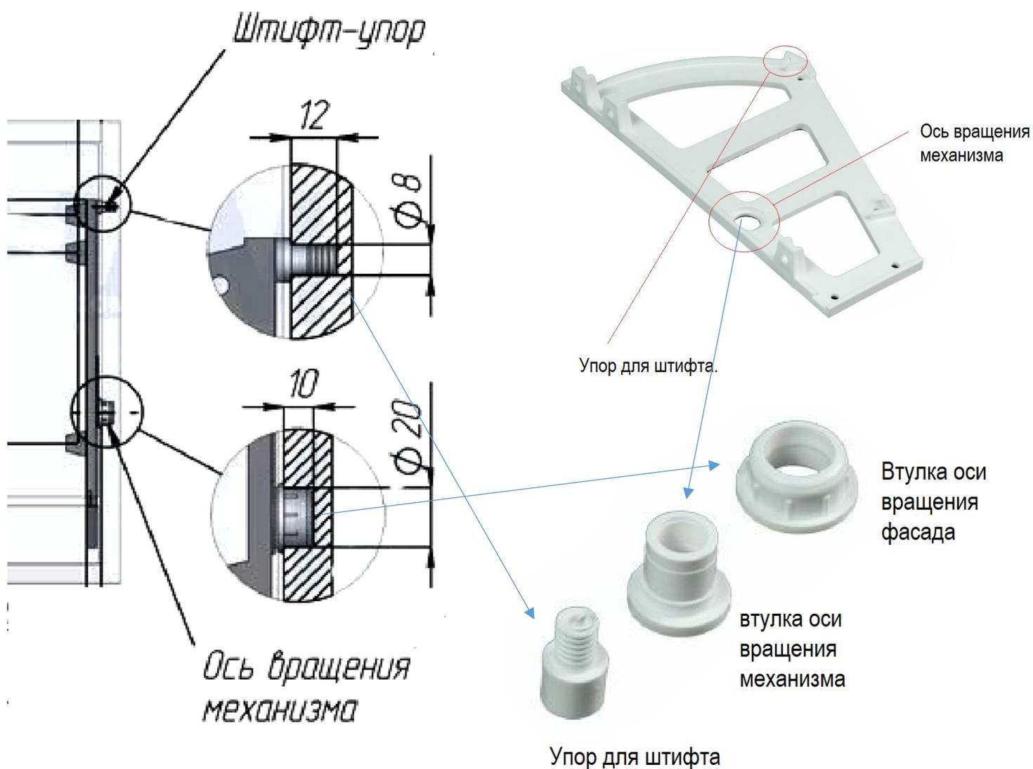
4. Просверлить отверстия под втулку и упор в соответствии с чертежом механизма во второй боковой стенке обувницы. Вставить втулку вращения фасада в отверстие боковой стенки обувницы. Вставить упор для штифта в отверстие боковой стенки. Вставить втулку оси вращения механизма. Собрать фасад обувницы.
