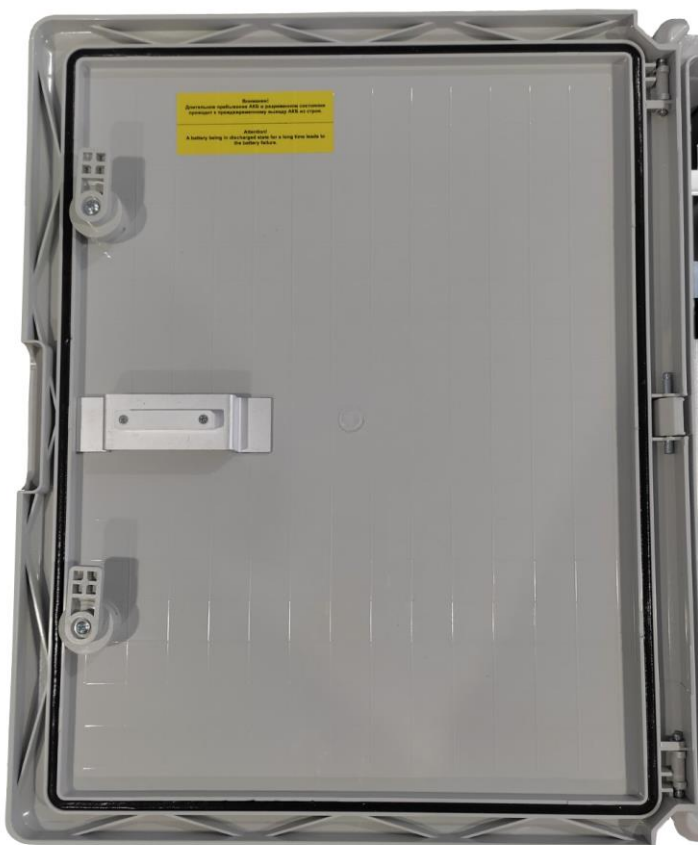
Рисунок 3.7.1 - Датчик вскрытия на крышке коммутатора
