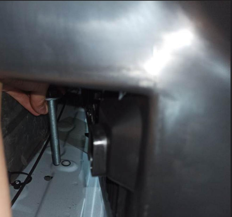
**Установить болты M12x100 (9) и шайбы 12 увел. (13) в дальние отверстия с двух сторон.**
