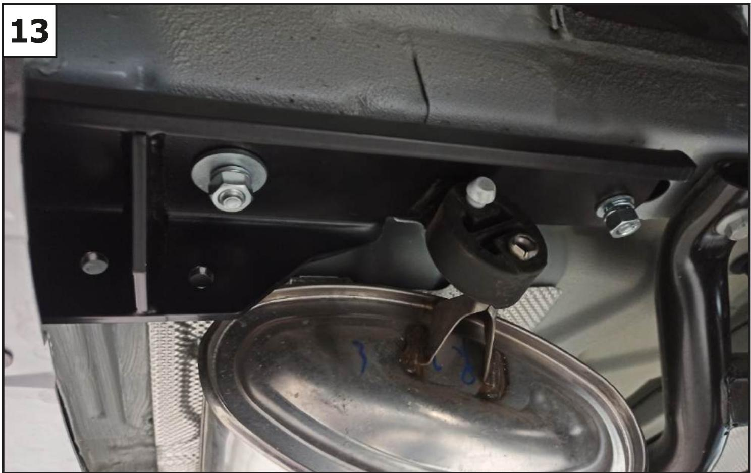
**Закрепить правый и левый кронштейн (3 и 2) с помощью гаек М12 (11), шайб 12 (12) и шайб 12 пружинных (14).**
