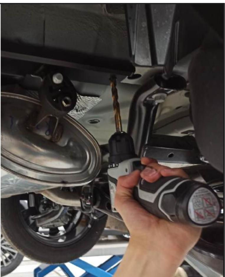
**Выставить кронштейны параллельно лонжеронам. Просверлить через дальние отверстия кронштейнов пол багажника сверлом диаметром 12,5 мм.**
