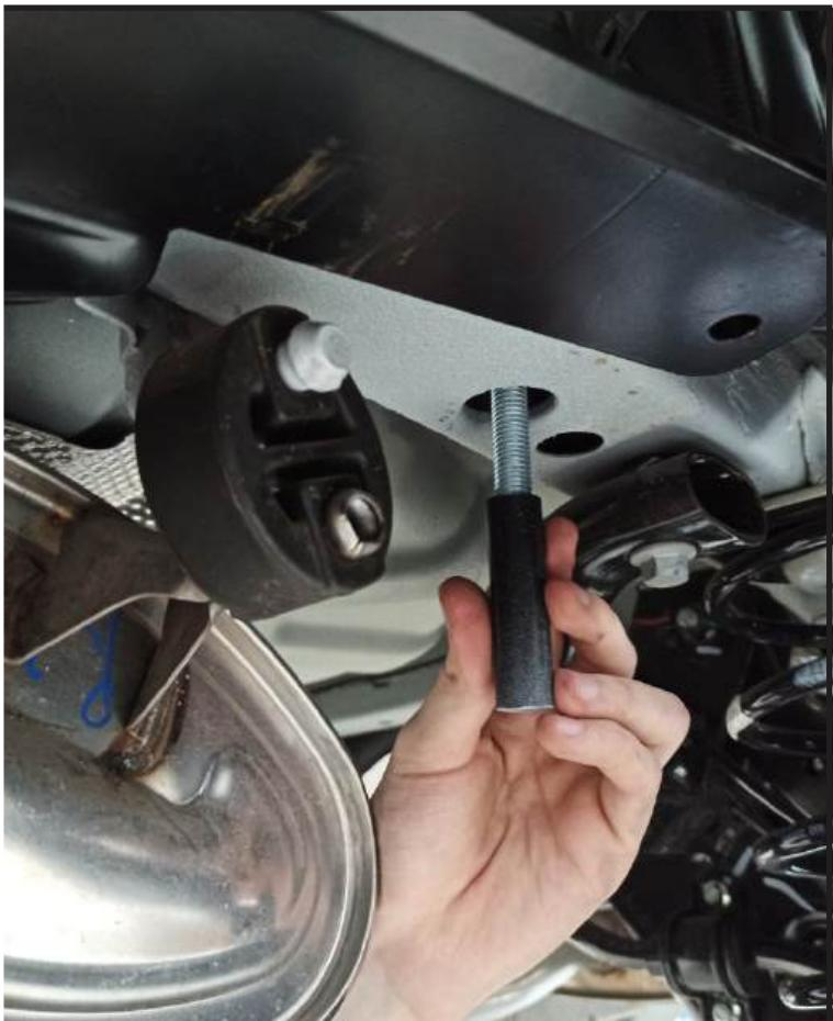
**Отодвинуть не закрепленную часть кронштейна и установить снизу втулки (15) в дальние отверстия.**
