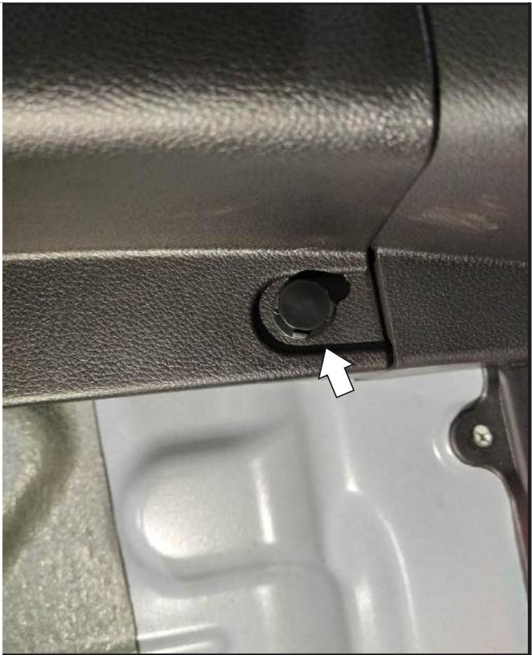
Демонтировать клипсы обшивки багажника.
