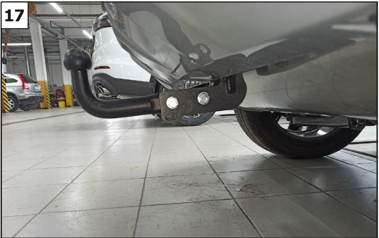
**Затянуть все резьбовые соединения. Моменты затяжки: M12=81Нм**
