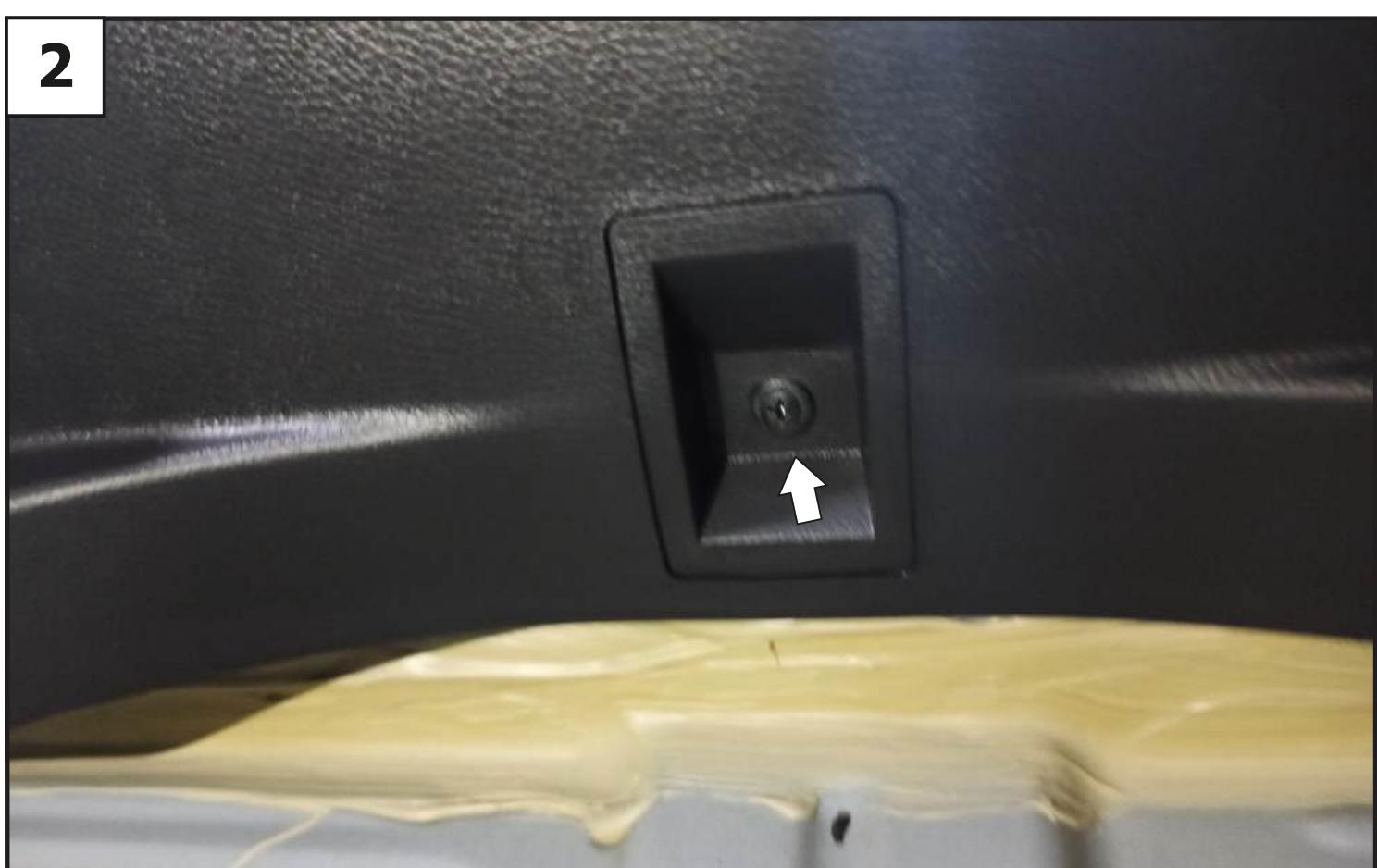
В центре накладки выкрутить винт обшивки багажника.
