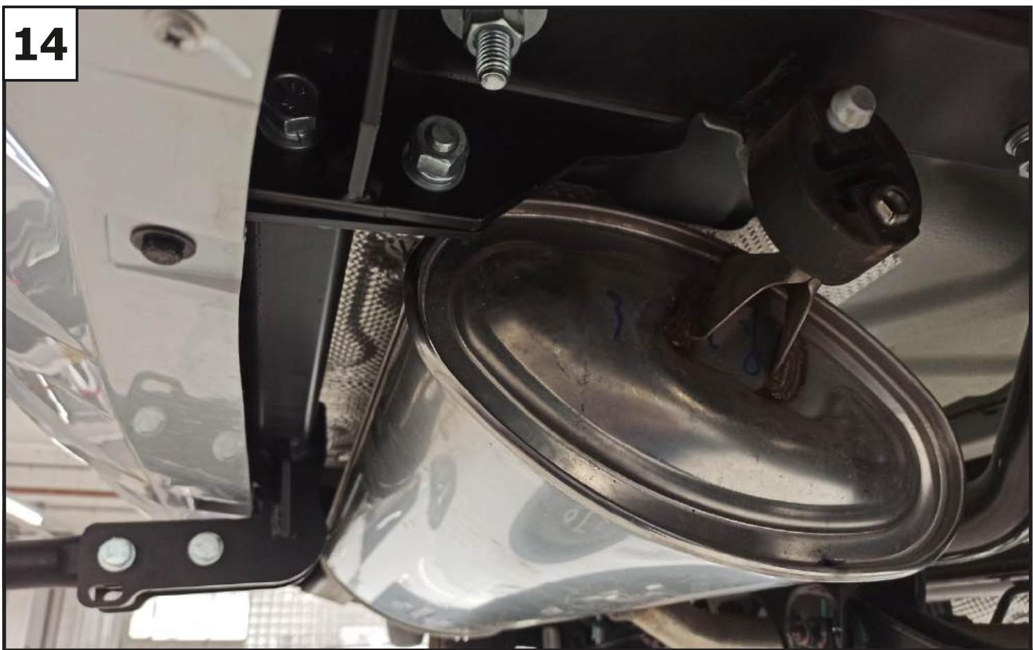
**К установленным кронштейнам закрепить балку (1) с помощью болтов М12x1,25x35 (7), шайб 12 (12), шайб 12 пружинных (14) и гаек М12x1,25 (10).**
