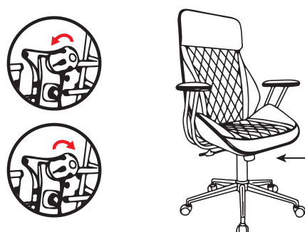
Регулировка жесткости качания / Swing stiffness adjustment / Тербелістің қаттылығын реттеу
