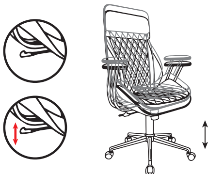
Регулировка высоты кресла / Seat height adjustment / Орындық биіктігін реттеу
