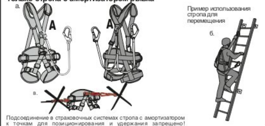
Рис. 6. Использование карабинов, входящих в состав стропов
