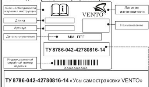
Рис. 2. Идентификация и маркировка изделия
