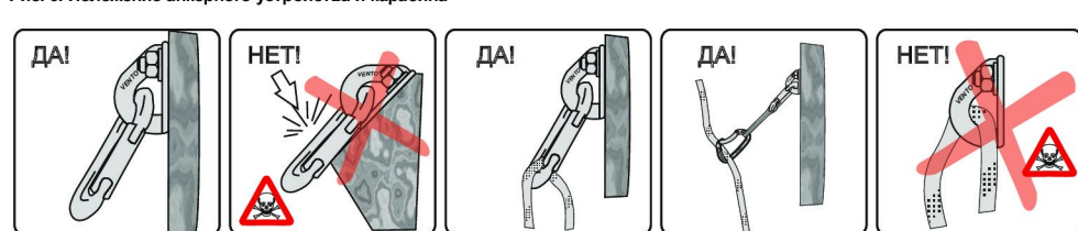
Рис. 6. Положение анкерного устройства и карабина
