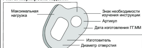
Рис. 2. Маркировка изделия
