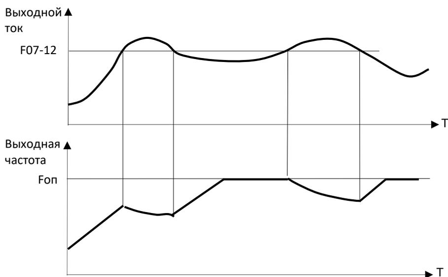
Ограничение тока действительно только для режима U/F. Рекомендуется использовать эту функцию в случае большой инерционной нагрузки или нагрузки вентиляторного (насосного) типа или приведения в действие нескольких двигателей одним ПЧ.
