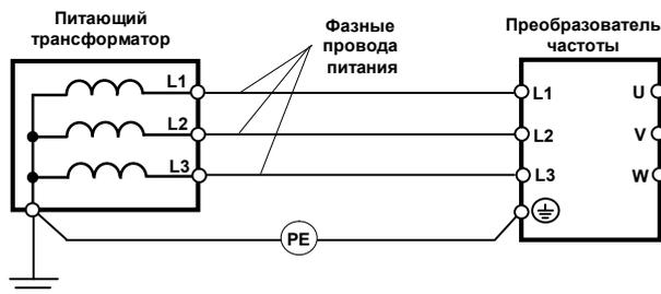
**Система заземления TT** – заземление ПЧ производится на отдельное заземляющее устройство, не связанное с заземляющим устройством питающего трансформатора
