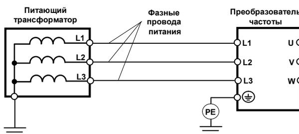
При использовании любой из вышеуказанных систем заземления запрещается подсоединять к клемме «Земля»  $\oplus$  ПЧ нейтральный рабочий проводник (N) или совмещенный нейтральный рабочий и защитный проводник (PEN), соединенные со средней точкой питающего трансформатора.
