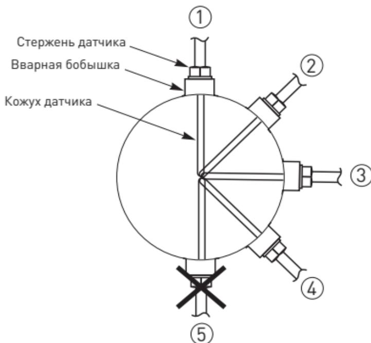
Рис. 5 - Точки установки датчика
