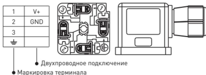
Вывод 4-20 мА (двухпроводная схема)
