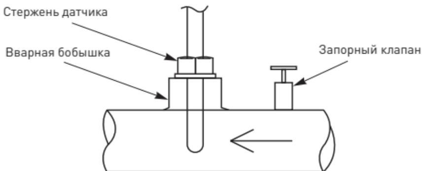
Рис. 4 - Схема установки датчика
