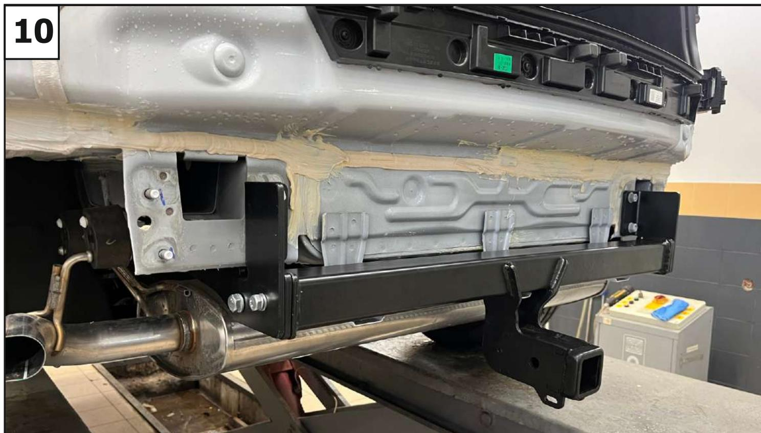
Установить балку (1) закрепив её к кронштейнам (2, 3) и усилениям кронштейна (4, 5) при помощи болтов M12x1,25x40 (16), шайб 12 (25), шайб пружинных 12 (26) и гаек M12x1,25 (19).
