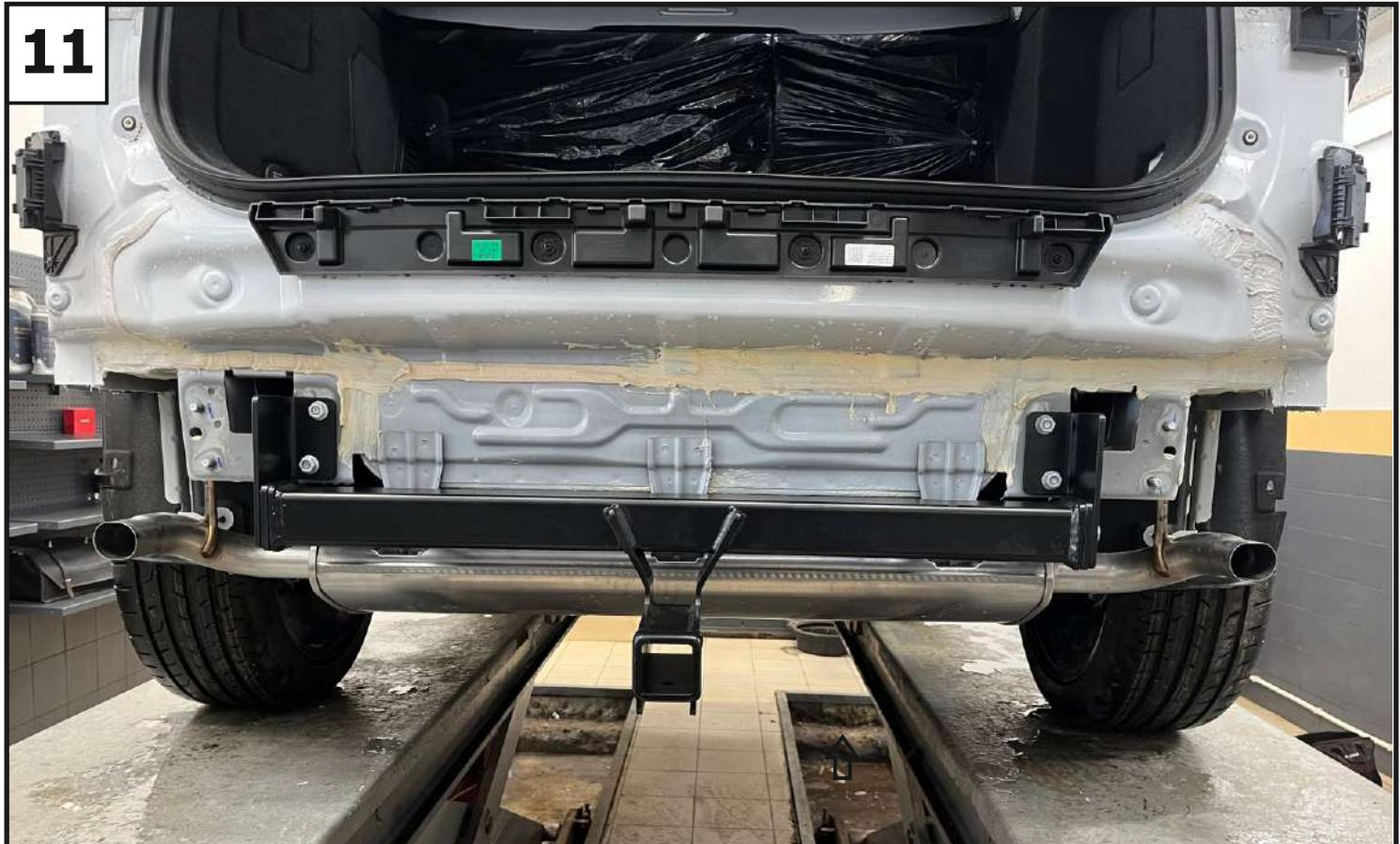
Отрегулировать положение ТСУ относительно центра автомобиля и затянуть все резьбовые соединения — сначала балку с кронштейнами и усилениями, затем усиления кронштейна к задней панели автомобиля, в последнюю очередь кронштейны с лонжеронами автомобиля. Моменты затяжки: M10=47 Нм, M12=81 Нм.
