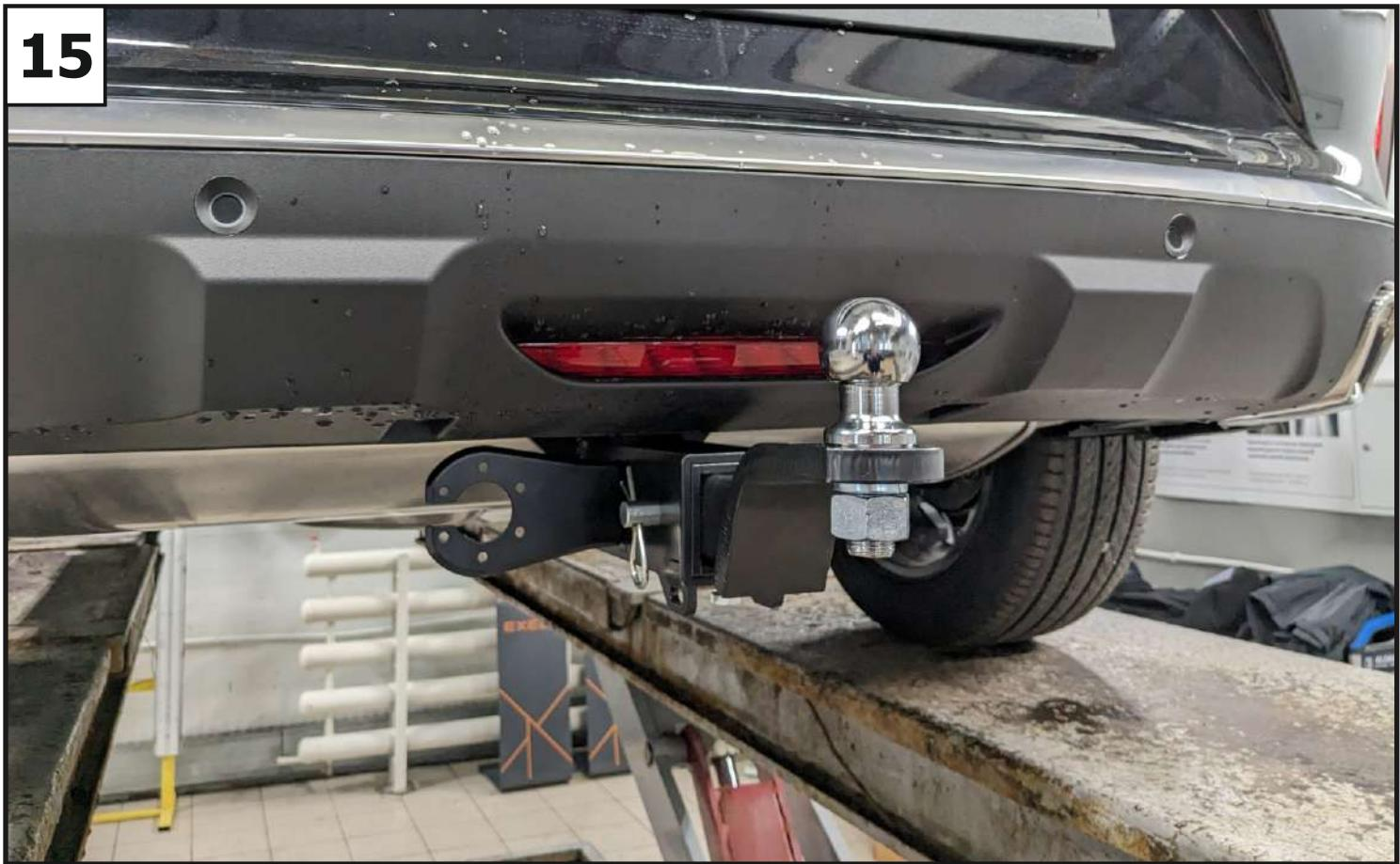
Установить переходник (6), закрепив с помощью штифта (8) и шплинта (9). Зафиксировать переходник болтом M10x20 (15) - фиксацию использовать только без нагрузки. Установить на переходник шар (7), закрепив гайкой M24 (28) с шайбой 24 пружинной (29).
