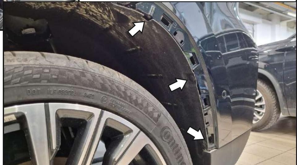
**Демонтировать боковую накладку, после чего выкрутить винт и демонтировать клипсы крепления бампера. С другой стороны аналогично.**
