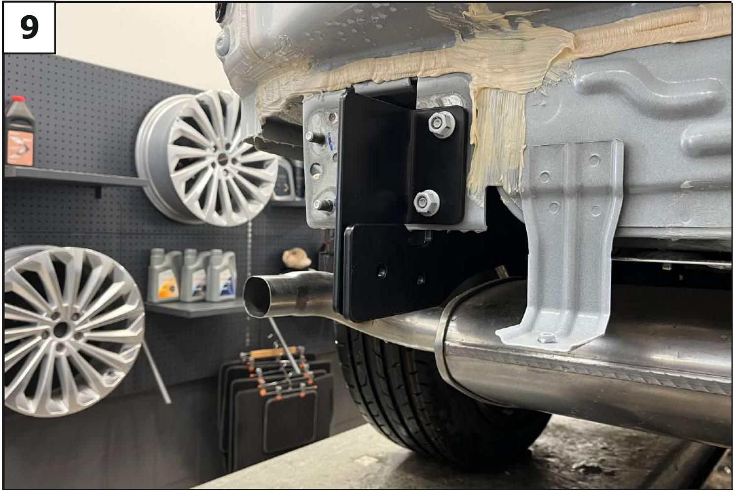
Установить левое усиление кронштейна (4) с помощью штатных гаек крепления усилителя. Правое усиление кронштейна (5) устанавливается аналогично.
