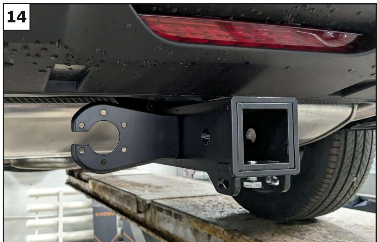
Установить кронштейн под розетку (10) на балку (1) с помощью болта M8x80 (14),
