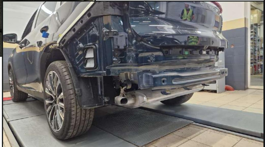
Отключить разъем электропроводки через технологическое окошко внутри багажного отделения и снять задний бампер.
