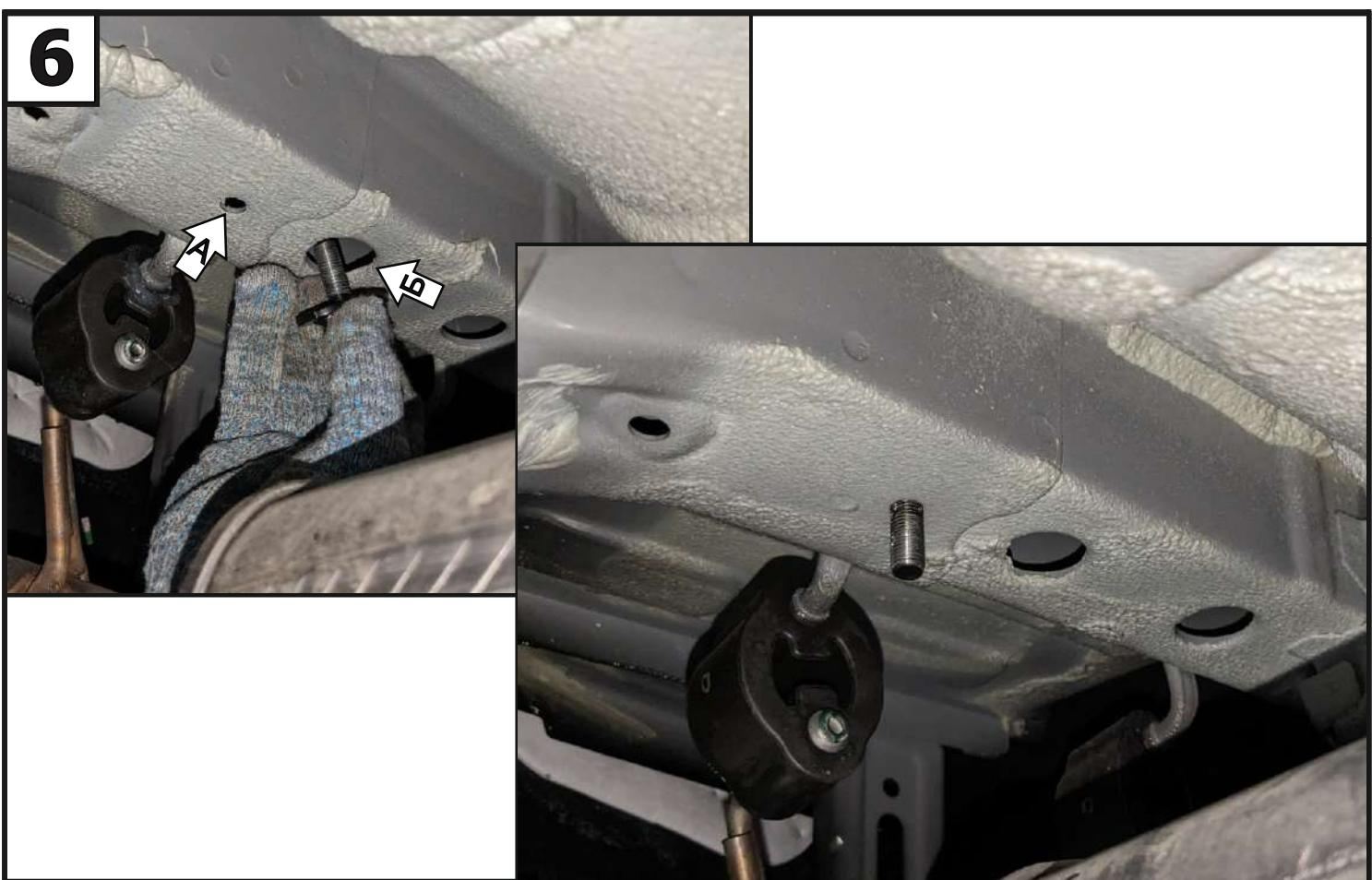
Установить закладную (10) в отверстие левого лонжерона А автомобиля через технологическое отверстие Б. С правой стороны аналогично.
