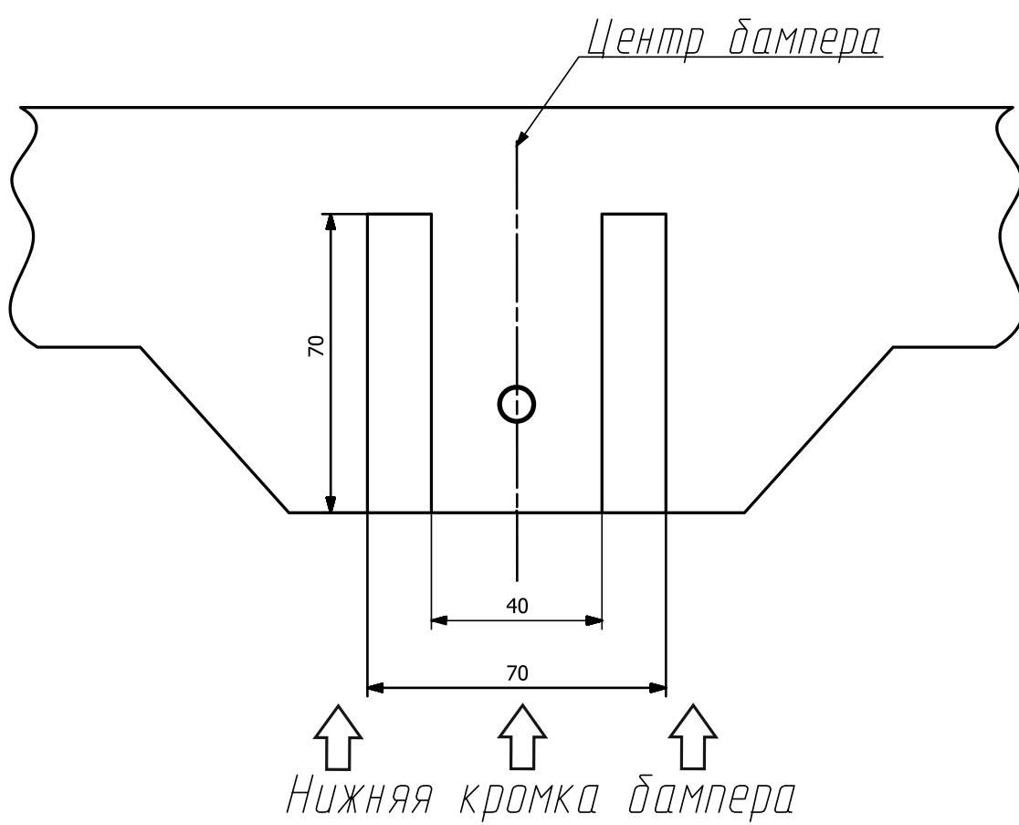
Выполнить подрезку бампера согласно схеме.
