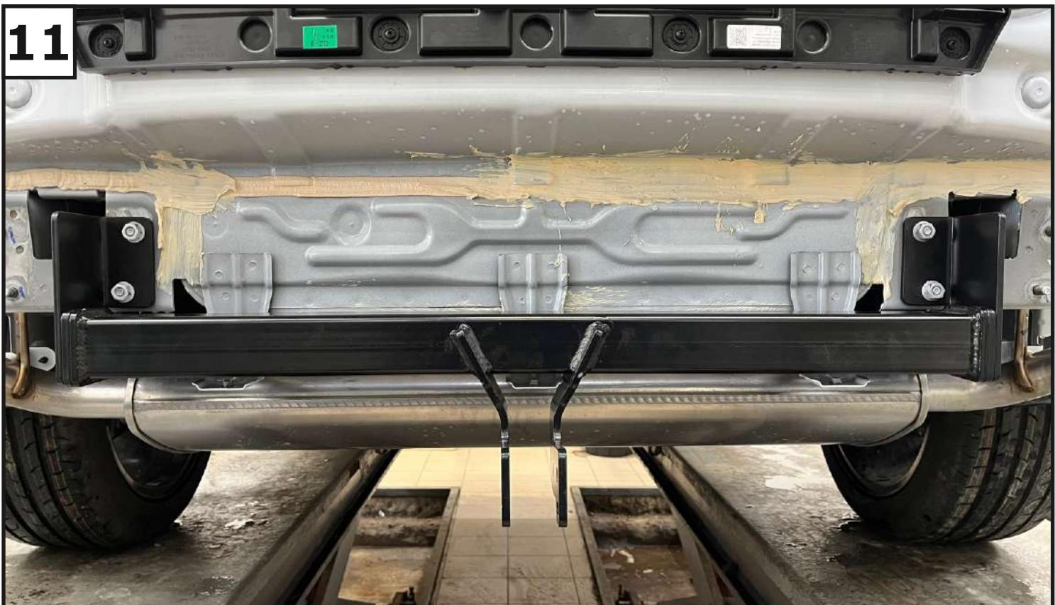
Отрегулировать положение ТСУ относительно центра автомобиля и затянуть все резьбовые соединения — сначала балку с кронштейнами и усилениями, затем усиления кронштейна к задней панели автомобиля, в последнюю очередь кронштейны с лонжеронами автомобиля. Моменты затяжки: M10=47 Нм, M12=81 Нм.
