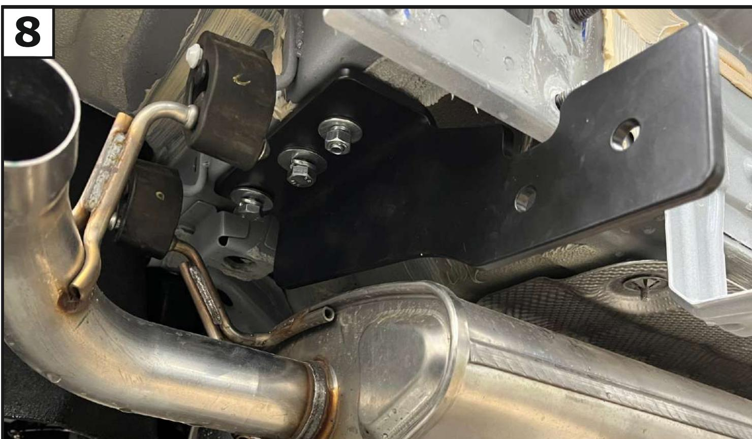
Установить левый кронштейн (2) совместно с проставками кронштейна (11), закрепив его к установленным закладным (9 и 10) с помощью болтов M12x1,25x40 (12), шайб 12 пруж. (18) и шайб 12 увел. (20), гаек M10x1,25 (14), шайб 10 пруж. (16) и шайб 10 увел. (17). Правый кронштейн (3) устанавливается аналогично.
