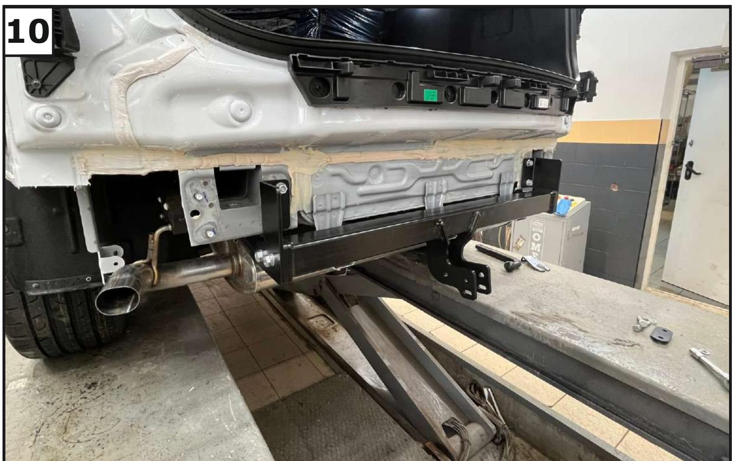
Установить балку (1) закрепив её к кронштейнам (2, 3) и усилениям кронштейна (4, 5) при помощи болтов M12x1,25x40 (12), шайб 12 (19), шайб пружинных 12 (18) и гаек M12x1,25 (15).
