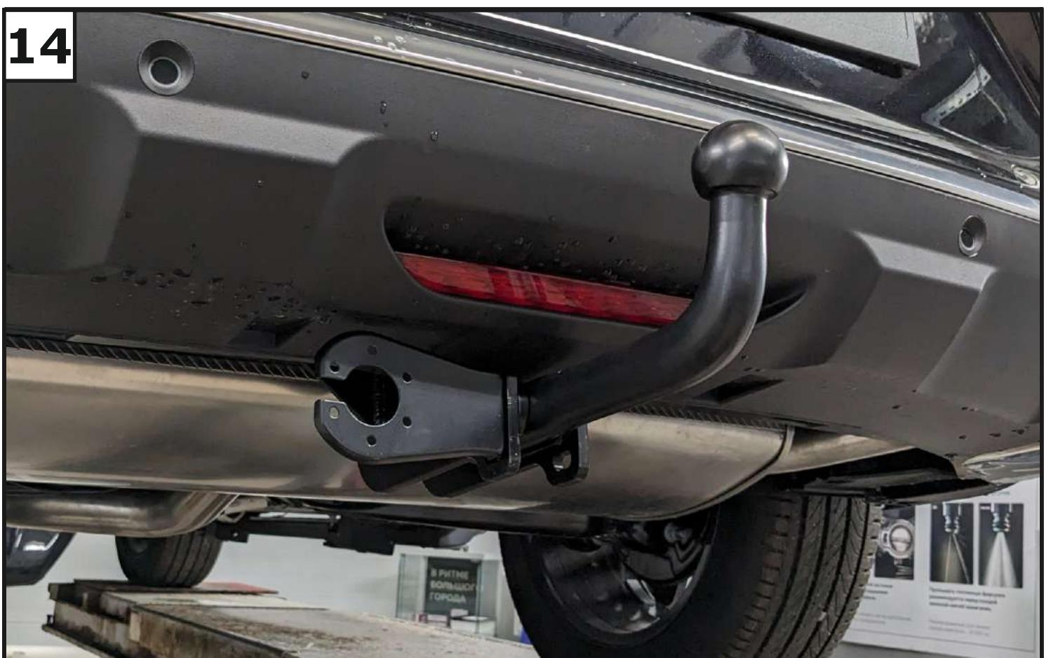
Установить и затянуть крюк (8) и кронштейн под розетку (7) на балку (1) с помощью болта M12x1,25x90 (13), шайбы 12 (19), шайбы 12 пружинной (18) и гайки M12x1,25 (15).
