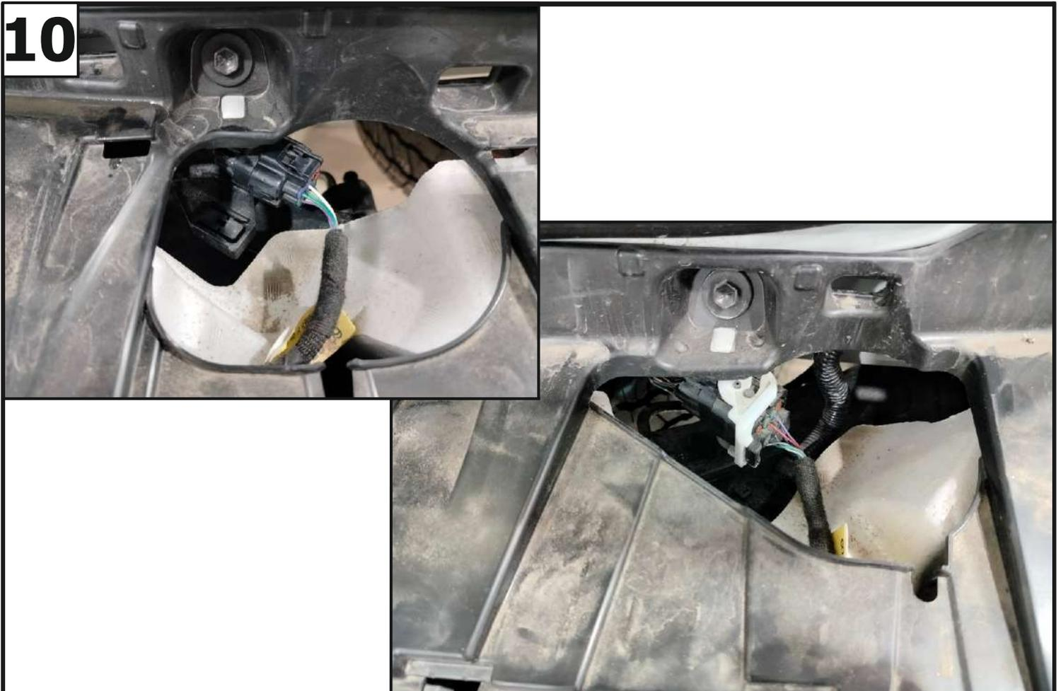
Отключить разъемы электропроводки и снять задний бампер.
