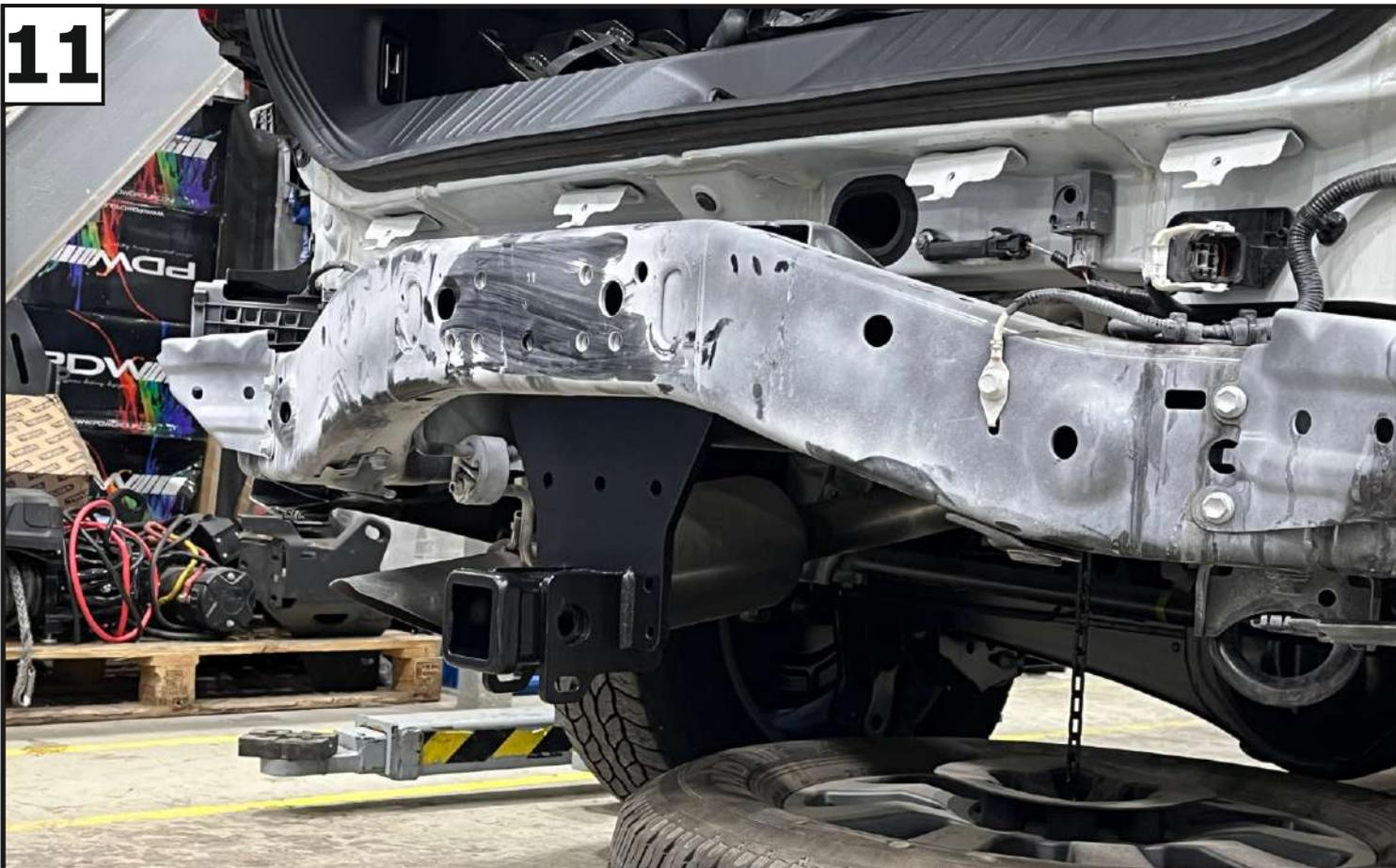
Снять запасное колесо и установить кронштейн (1) с обратной стороны поперечины рамы, закрепив его с помощью болтов М12х1,25х40 (11), шайб 12 пружинных (22) и шайб 12 (21).
