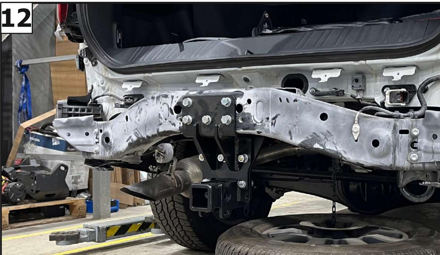
Установить усиление (2), закрепив его к поперечине рамы и к кронштейну (1) с помощью болтов М10х1,25х40 (10), болтов М12х1,25х40 (11), болтов М12х1,25х50 (12), гаек М10х1,25 (14), гаек М12х1,25 (15), шайб 10 (19), шайб 10 пружинных (20), шайб 12 (21) и шайб 12 пружинных (22).
