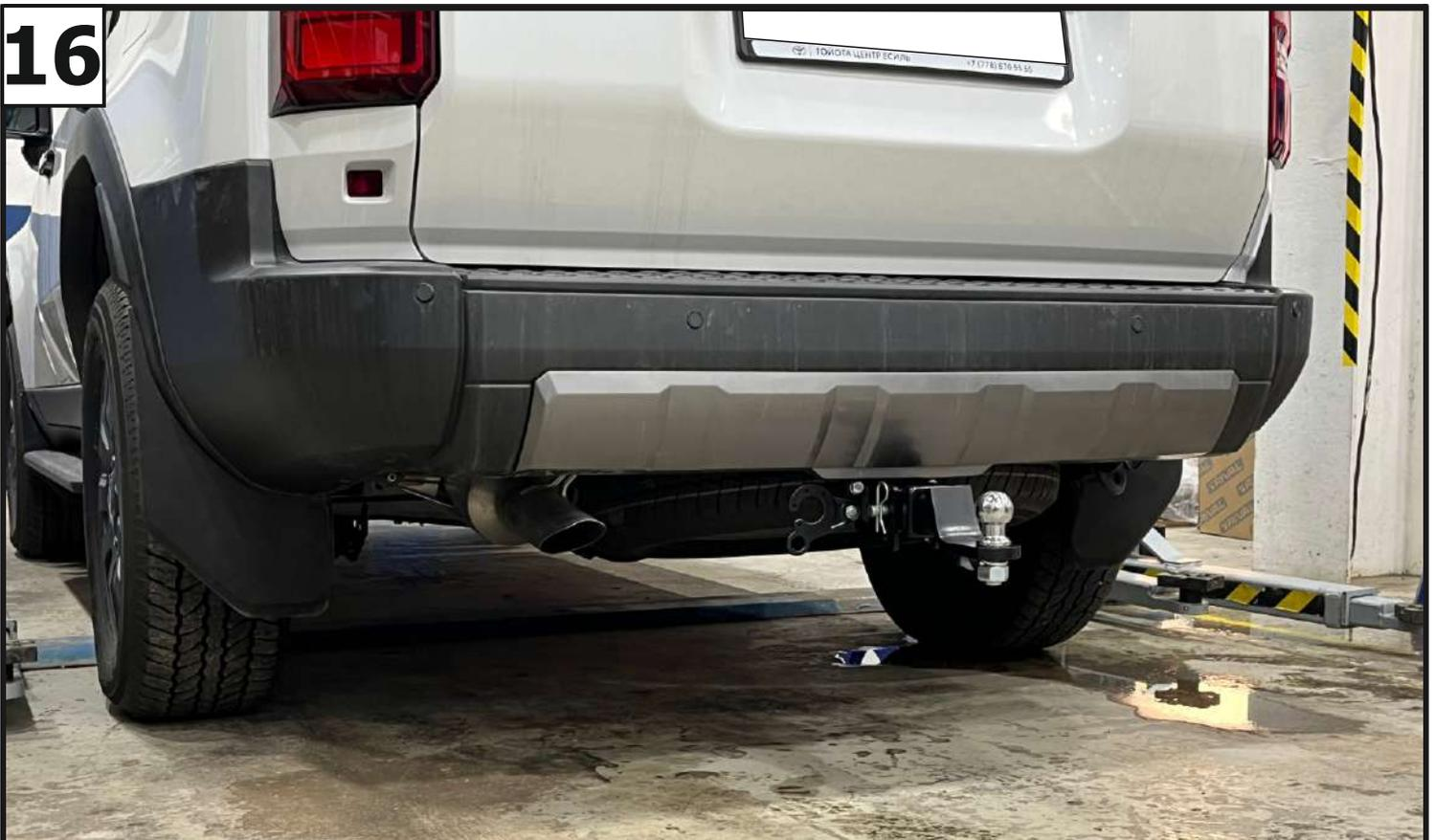
Установить переходник (3), закрепив с помощью штифта (5) и шплинта (6). Зафиксировать переходник болтом М10х20 (9) - фиксацию использовать без нагрузки. Установить на переходник шар (4), закрепив гайкой М24 (23) с шайбой 24 пружинной (24). Момент затяжки: М24=95 Нм.
