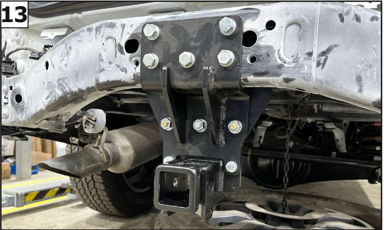
**Затянуть все резьбовые соединения: сначала кронштейн (1) с усилением (2), затем кронштейн (1) с поперечиной, после усиление (2) с поперечиной. Моменты затяжки: М10=47 Нм, М12=81 Нм.**
