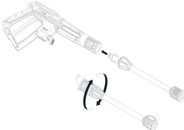
Вставьте насадку для моющего средства таким же образом. Выбирайте насадку, которая лучше всего подходит для очищаемой поверхности. Одновременно в пистолет можно вставить только одну насадку. Все насадки должны быть правильно вставлены в пистолет.
