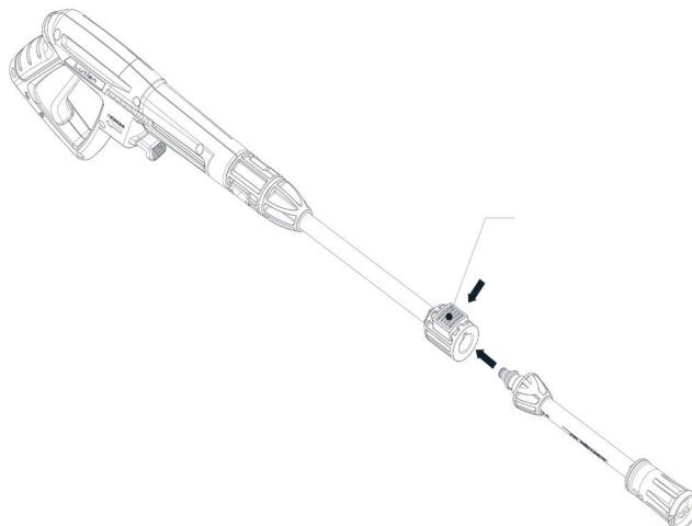
Вставьте регулируемую форсунку (D) в удлинитель (E) с помощью быстрого съемного соединения. Вам нужно надавить на удлинитель (E) с усилием до упора рукой, чтобы зафиксировать его. Когда детали соединены правильно, вы не сможете разделить два компонента, потянув за удлинитель (E).
