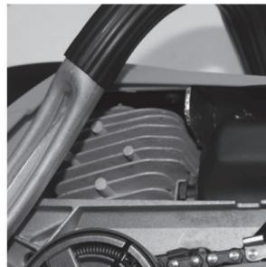
Грязные ребра цилиндра двигателя могут стать причиной его перегрева и поломки. Регулярно очищайте от загрязнений ребра цилиндров кисточкой и/или сжатым воздухом.
