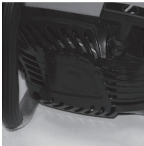
При загрязнении охлаждающих отверстий стартера продуктами распила и масляным шламом используйте для очистки кисточку и/или баллон со сжатым воздухом.
