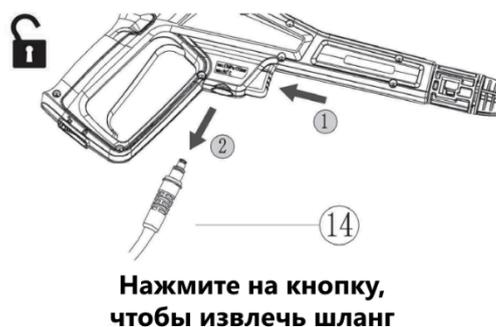
**Примечания.** После подсоединения шланга высокого давления немного потяните за него, чтобы убедиться, что он надёжно подсоединён. Чтобы отсоединить шланг высокого давления, нажмите на переключатель блокировки и потяните за шланг. Чтобы шланг было проще отсоединить, слейте остатки воды из пистолета – для этого убедитесь, что переключатель находится в положении «OFF/O», и нажмите на спусковой крючок.
