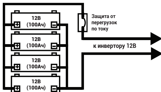
Блок аккумуляторов на 12 В (общая емкость = 400 Ач)
