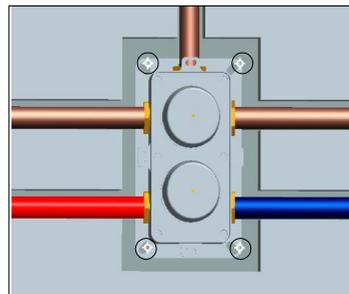
4. Установите монтажный блок и просверлите отверстия на стене, вставьте пластмассовые дюбеля.
