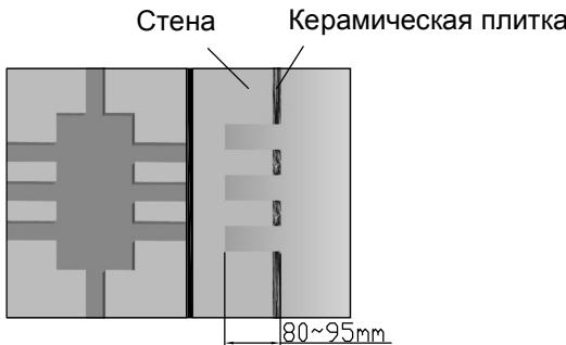
2. Присоедините водопроводную трубку с монтажной коробкой
