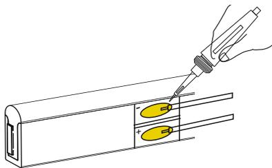
1. Пайка ленты гибкой печатной платы осуществляется легкоплавкими припоями на основе сплава олова и свинца серии ПОС с температурой плавления в диапазоне 183 – 300 градусов Цельсия.
