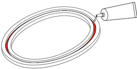
Хорошую адгезию имеет клей-герметик силикон Пентэласт-1143. Незаменим для мест с повышенной влажностью, приклеивания декоративных торцов заглушек, склеивания в кольцо.
