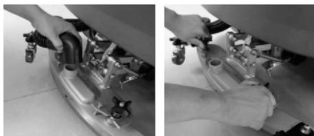
При установке скребка проверьте, не изношены ли водосборные резинки. Если одна кромка резинки изношена, переверните ее другой стороной. Если обе стороны резинки изношены, замените резинку на новую. Водосборная резинка с вырезами устанавливается спереди, гладкая водосборная резинка ставится сзади.
