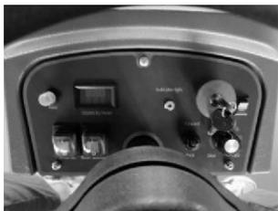
4. При отпускании педали хода машина автоматически останавливается. Выключите моторы щеток и вакуумный мотор кнопками (при этом щеточная дека и задний водосборный скребок должны подняться в верхнее положение), выключите зажигание и прекратите уборку.
