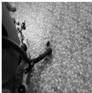
4. После того, как грязная вода будет полностью слита, поднимите крышку бака и промойте внутреннюю полость бака чистой водой.
