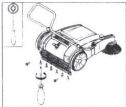
14. Порядок снятия и установки заднего пыльника основной щетки.
