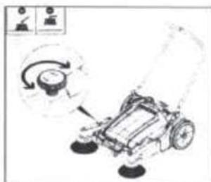
1. Зафиксируйте передние щетки винтами с помощью отвертки.
