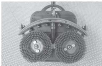
Водосборный скребок необходим для сушки влажного пола. Он уже смонтирован на машине на заводе, но не отрегулирован.
