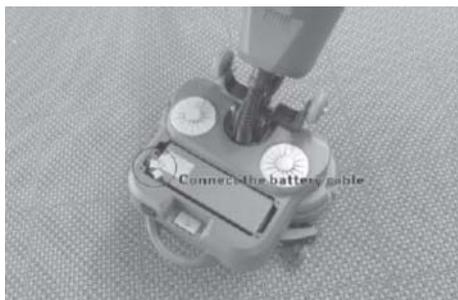
Подсоедините батарею к машине с помощью разъемов. Для этого:
