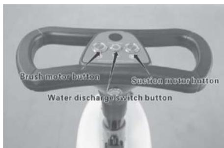
**Левая кнопка:** кнопка включения и выключения мотора моющей щетки.
