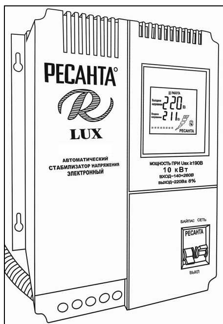
Рис.9. Показания дисплея после включения
