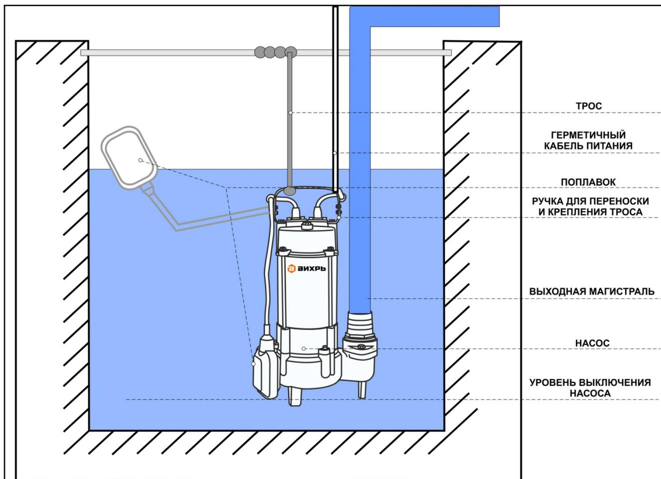
Рис.2 Монтаж насоса
