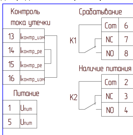
Рисунок 3.2. Схема электрическая подключения реле
