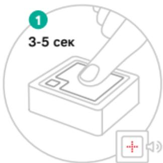
Нажать и удерживать кнопку датчика протечки до появления на нём световой индикации.
