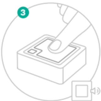
Для проверки сопряжения достаточно короткого нажатия на кнопку датчика.
