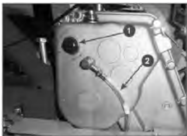
Рис. 13 Заправка масла в коробку передач 1. Пробка маслозаливного отверстия 2. Трубка для контроля уровня масла в коробке передач
