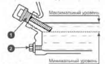
Рис. 12 Проверка уровня масла в картере
