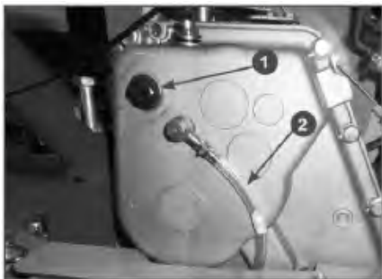
Рис. 23 Заправка масла в редуктор
