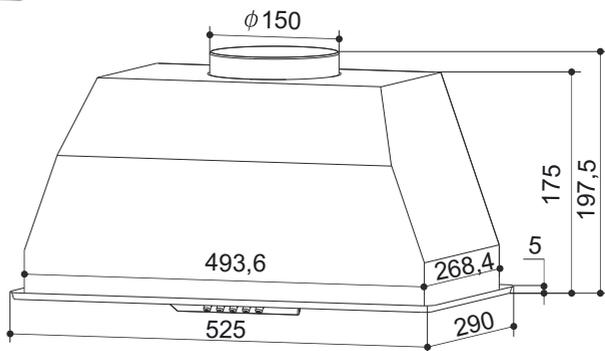
Рис. 1 Внешний вид кухонной вытяжки и схема размеров
