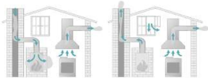
Рис. 3 Одновременная эксплуатация вытяжки и устройства горения
